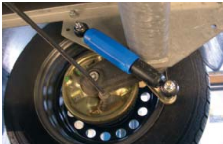
Un kit de montage d'amortisseurs du constructeur pour une installation après-coup coûte par essieu environ Fr. 600.-. A l'achat d'une nouvelle remorque, la majoration de prix est d'env. Fr. 250.-.
