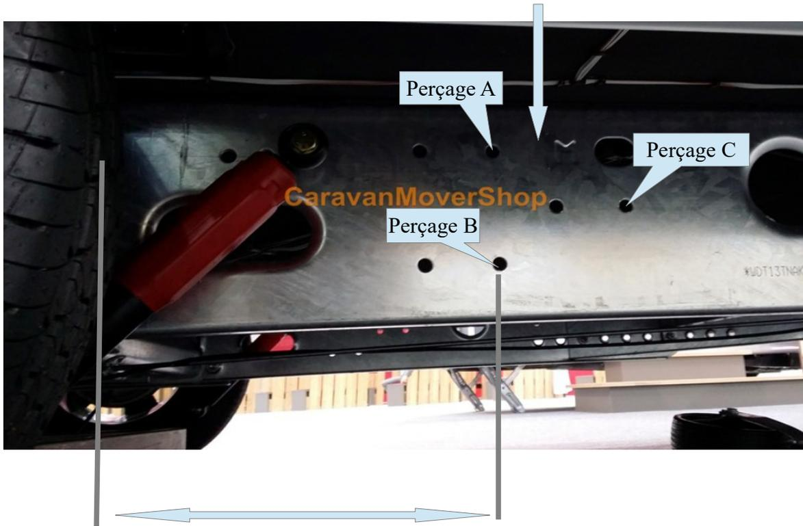
Diamètre perçage A / B / C = 12 mm
