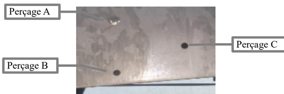
Diamètre perçage A / B / C = 12 mm
