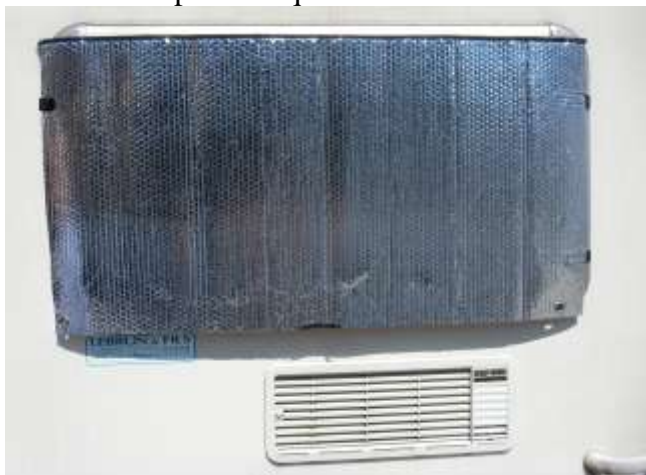
Store isolant pour chaque baie
